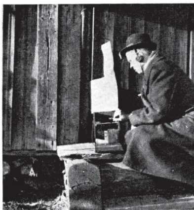
OH2NV:n kannettava 420 Mj:n transceiver kokeilussa Keravalla v. 1948. Putki 95,4-acorn triodiksi kytkettyinä.
