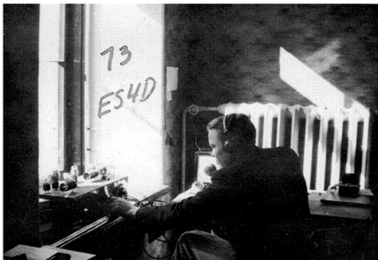
Olev Saarep'in ES4D kanssa olin yhteydessä kutsulla XOH2PW Pellingistä 40 metrillä ja 3:lla watilla 25/2 1937. ES4D:n Tx cc 33-43-2x43 15watt. Rx 1-V-1, ant Zeppelin 40 m. Kuva otettu syyskuussa 1936. QTH: PORKUNI.
