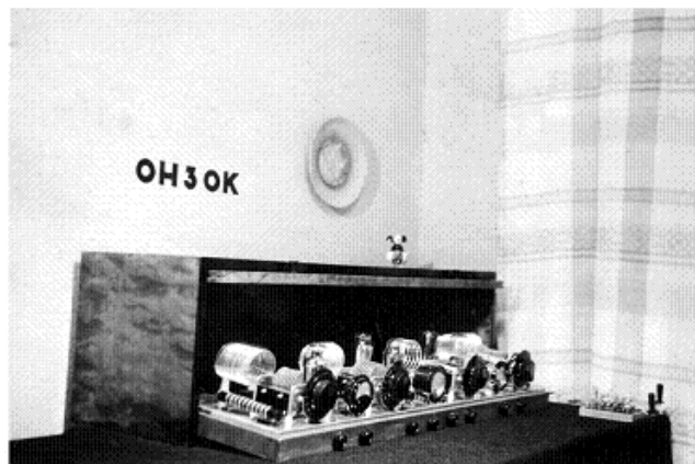
Solmu Kantolan rigit Tx T.P.T.G 20 wattia,Rx O-V-2 ja antenni V.F.Hertz 41 m.Kuva saatu 10.11.39.
