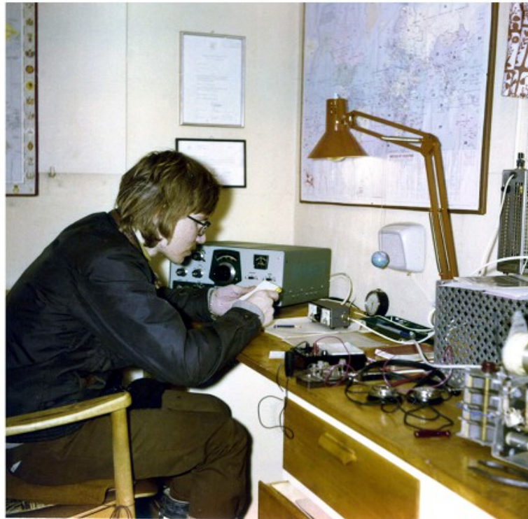
Tapani 2BMV mittailemassa 2PW:n antennien SWR-suhteita.
