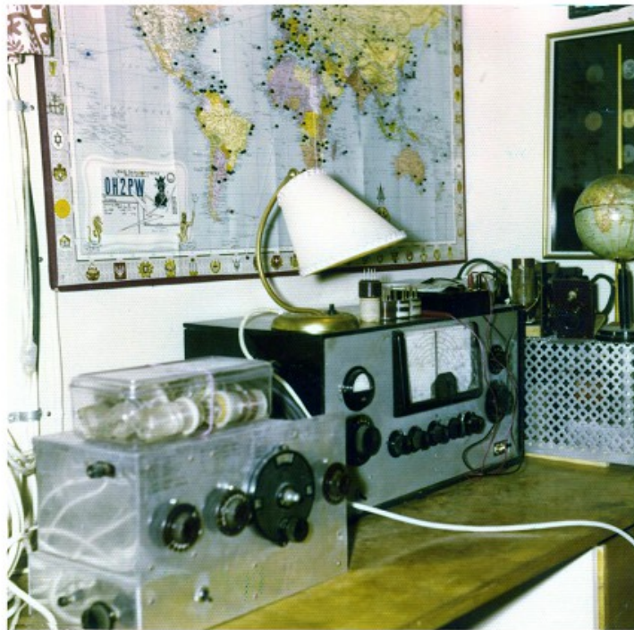
Oh2PW:n laitteita:Etualalla vanha luotettava 3-putkinen vastaanotin,joka on rakennettu "The Radio Amateur's Handbook'in 1937"mukaan ja keskellä kide ohjattu 3-putkinen 20-25 w lähetin,joka rakennettu saman vuoden"Handbookin" mukaan ja myöhemmin muutettu Gelson VFO-lla varustetuksi. Taustalla poweri.
