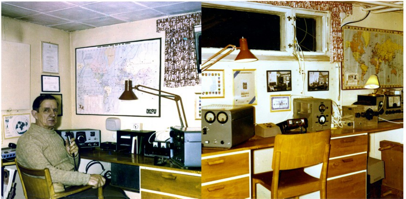
Oh2PW:n asema 1975:Tranceiver HW100ja lineaarinen,oikealla keskellä 2 metrin tranceiver GTX-200 2/30 w,antenni 10-el. yagi.
