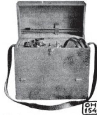
Tämä on 7NF:n kone. Myöskin 7NB:llä on samanlainen. Kaikki koneet ovat ulkomuodoitteen samantyyppisiä ja samankokoisia voidaksemme kokeillessa käyttää C-asettien kantotelineitä. Koneen kokonaispaino 10 kg.
