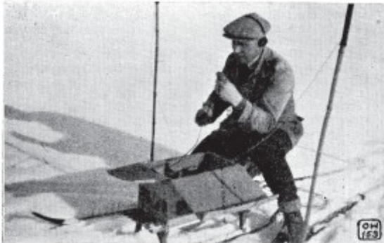
OH7ND helmikuussa 1934, alkukokeet jäällä, välimatka kuvanottoheikellä 5 km. Myöhemmin saimme samoilla koneilla yhteyden 16 km välimatkalla. Teho 0,8 wattia. Koneet "transceiver" mallia. Putket: oskillaattori ja ilmaisain B 409, modulaattori ja mj-vahvistin pentodi B 443. Antenni dipoli kuten kuvasta näkyy.
