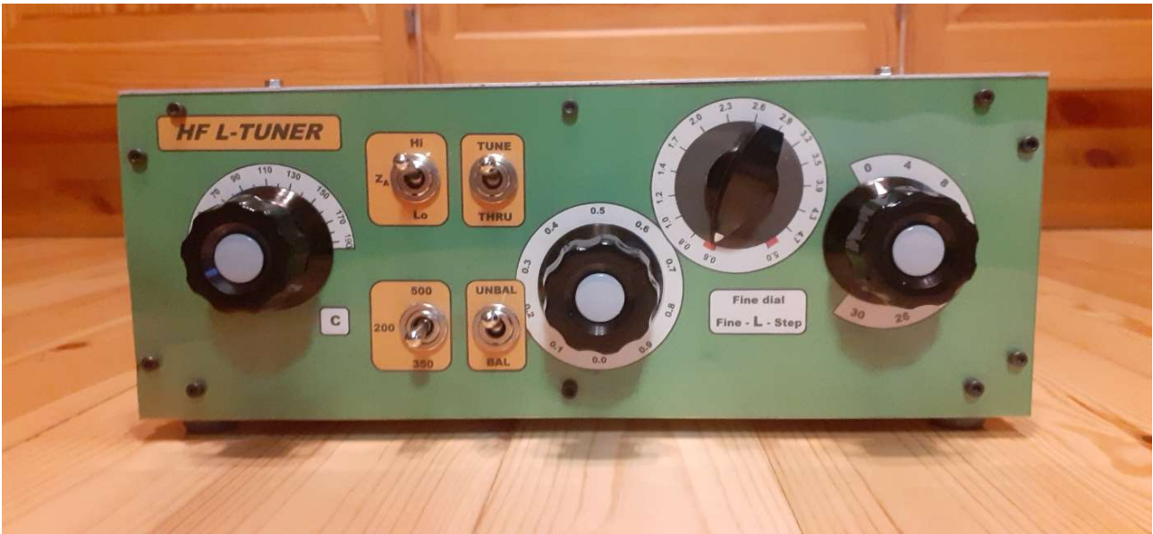
Kuva 13. L-sovittimen hallintalitteet. kondensaattori on vasemmalla, välissä valintakytkimet, keskellä säätökela ja sen asteikkonäyttö ja lopulta kelan stepperi.
