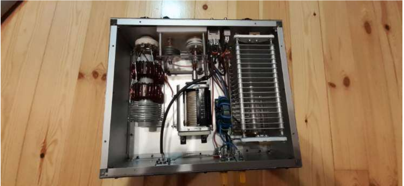
Kuva 15. Piiritekninen toteutus. Oikealla kondensaattori, keskellä rolleri ja vasemmalla lisäkelat. Lähdön baluni on konkan ja rollerin välissä.
