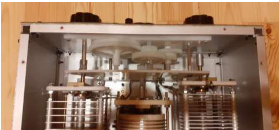
Kuva 6. Rollerikelan indikaattorin 1:30 hammaspyörävaihteisto.
