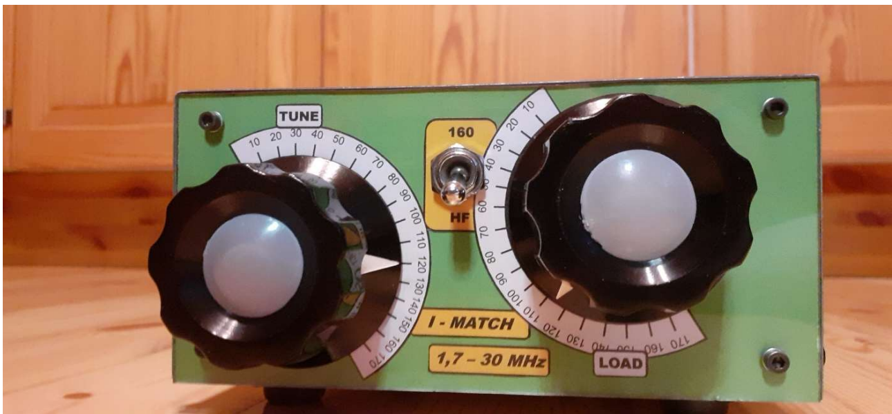
Kuva 23. I-sovittimen hallintalaitteet. Laite on perin teräväviritteinen, joten se kaipaisi planeettavaihteita säätöakseleihin. Minulla ei semmoisia ollut, joten laitoin tosi isot nupit. Asteikot ovat ympyrän asteita (0-180°), eivät kapasitanssiarvoja tällä kertaa.
