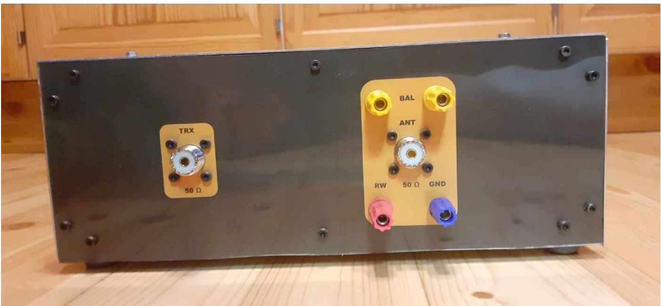
Kuva 14. KytKentärajapinta takalevyssä. Vasemmalta sisään ja oikealta ulos.
