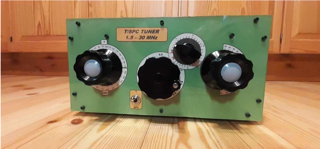
Kuva 3. T-sovittimen hallintalaitteet. Signaalitie kulkee oikealta vasemmalle. Oikealla on siten tulopuolen sarjakondensaattori ja vasemmalla lähtöpuolen kondensaattori. Keskellä on rollerikelan säätökampi ja siitä yläoikeaan on kelan asteikko. Kytin keskellä alhaalla vaihtaa T- SPC-toimintojen välillä.
