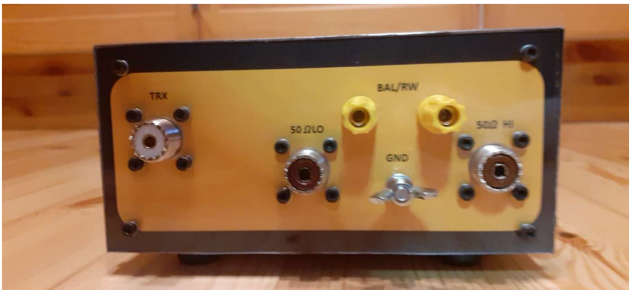
Kuva 23. I-sovittimen hallintalaitteet. Laite on perin teräväviritteinen, joten se kaipaisi planeettavaihteita säätöakseleihin. Minulla ei semmoisia ollut, joten laitoin tosi isot nupit. Asteikot ovat ympyrän asteita (0-180°), eivät kapasitanssiarvoja tällä kertaa.
